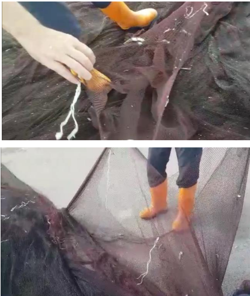
Figura 29 Numerosas roturas por captura de atún rojo en el copo 07/10/20 Arenys, reparación en tierra, labores de marcado.
